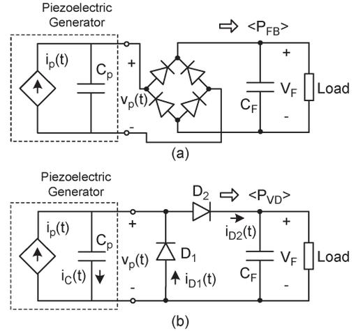
Fig. 2. (a) FB and (b) ac-dc VD rectifiers.
